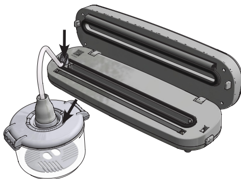
Фигура 6: Вакуумно запечатване на вакуумни съдове.
