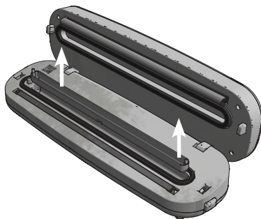
Фигура 5: Когато течност попадне във вакуумния канал, повдигнете тавичката за течности (Liquid Trap) директно нагоре, излейте течността, измийте и подсушете тавичката старателно.
